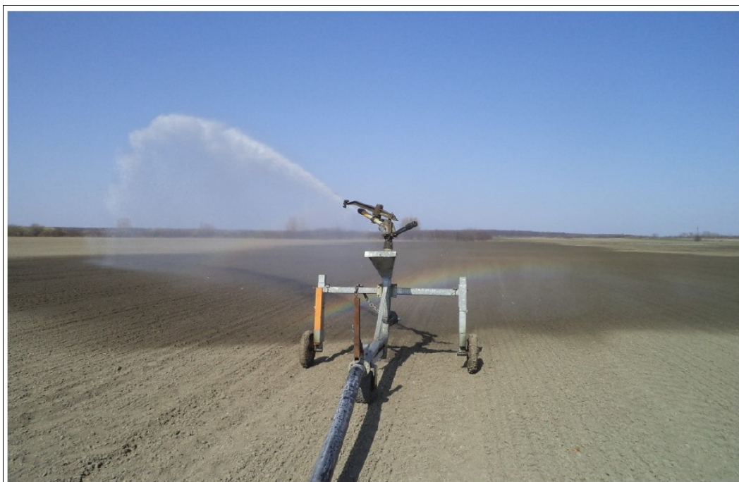
Slika 2. Kišenje površine samohodnom sektorskom prskalicom (Izvor: Glavni projekt – izgradnja bunara i navodnjavanja poljoprivrednih površina, 108/2022, TORZO d.o.o., Lovas, prosinac 2022.)
